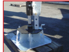
Calage hydraulique et système de sécurité de chantier
