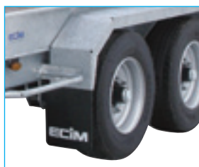
Les bavettes anti-projection captent l'eau projetée par les pneumatiques et en redirigent plus de 70% vers le sol, à l'abri des turbulences.
