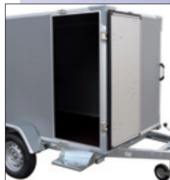
■ Porte latérale (largeur 600 mm) avec marche pied
