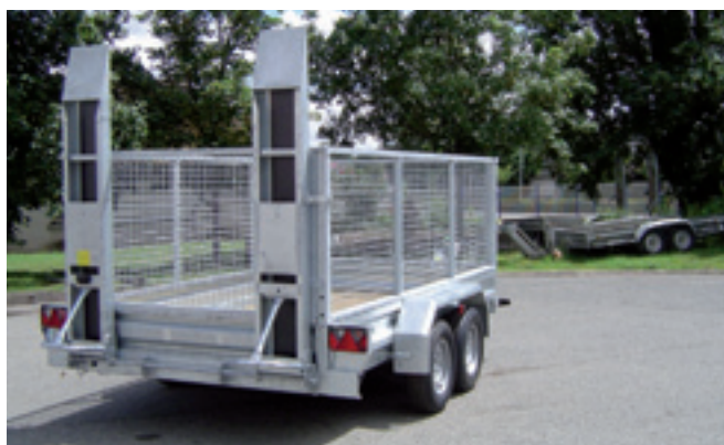
Options rehausses grillagées et ridelle arrière
