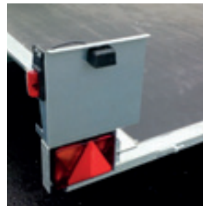
Support de plaque minéralogique pivotant
