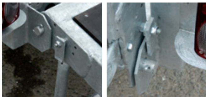
Blocage transversal des rampes par plat de retenue articulé
