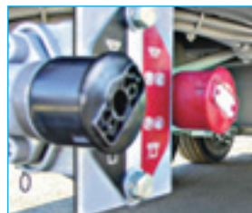
Frein de parc à commande pneumatique.
