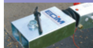
Antivol coiffant pour anneau avec support intégré sur la remorque
