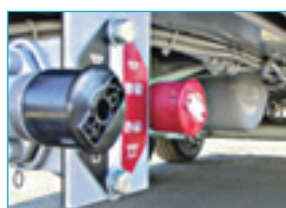
Frein de parc à commande pneumatique.
