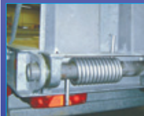
Aide au relevage des rampes.
