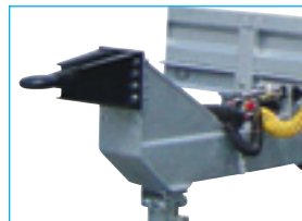
Anneau réglable en hauteur 890 à 990 mm.
