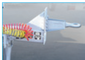
Anneau réglable en hauteur 770 à 970 mm.
