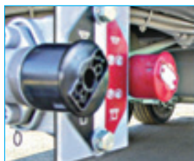
Frein de parc à commande pneumatique.
