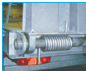
Aide au relevage des rampes.
