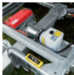
Pompe électrique avec batterie et boîtier de commande aimanté.
