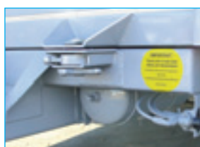
Fermeture sécurisée très robuste par système de verrou type conteneur.
