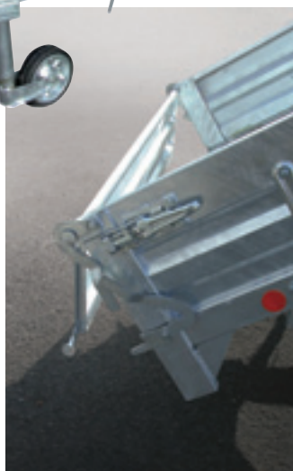
Ridelle arrière basculement par le haut
