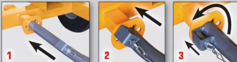
Dispositif d'attelage "Sécurité" breveté. Homologué par l'UTAC suivant le règlement 55 de la CEE-ONU - **Brevet ALTRAD.**
