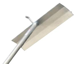
**ÉPANDEUR À BÉTON**
