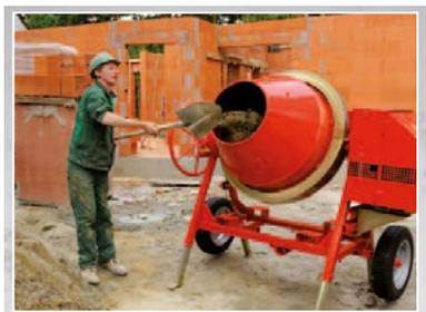
Roues gonflables montées sur roulements à billes et suspensions
