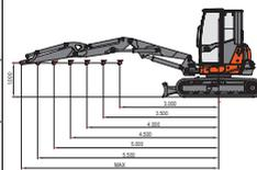
La capacité de levage est basée sur la norme ISO 10567 est elle ne dépasse pas au-delà du 75% du charge statique de basculement ou au-delà du 87% de la capacité de levage hydraulique de la machine.
