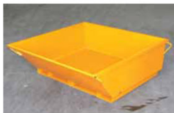
TRANSKOLL 500 L poids : 90 kg - épaisseur tôle : 2,3 mm dim. intérieures : 1230 x 1220 x 400 mm dim. extérieures : 1370 x 1270 x 505 mm
