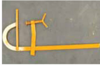
SERRE-JOINT ÉQUERRE simple serrage 500 à 1100 cm
